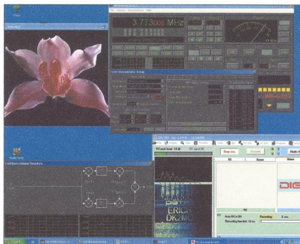
Bild 8: Professional Demodulator mit Echtzeit-Spektrogrammen; gemessen werden exakt 90° Phasendifferenz zwischen I- und Q-Signal.
